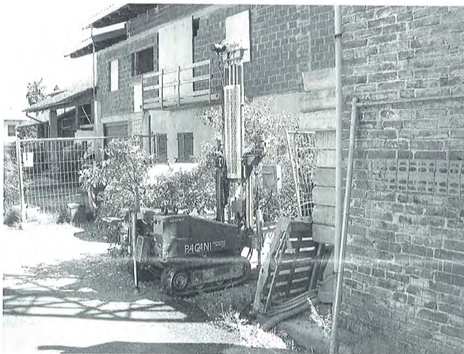
Foto 2 – L'esecuzione della prova penetrometrica DIN 2
