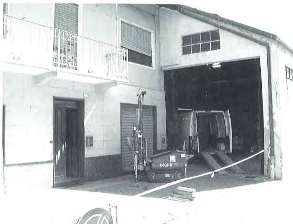
Foto 1 – L'esecuzione della prova penetrometrica DIN 1
