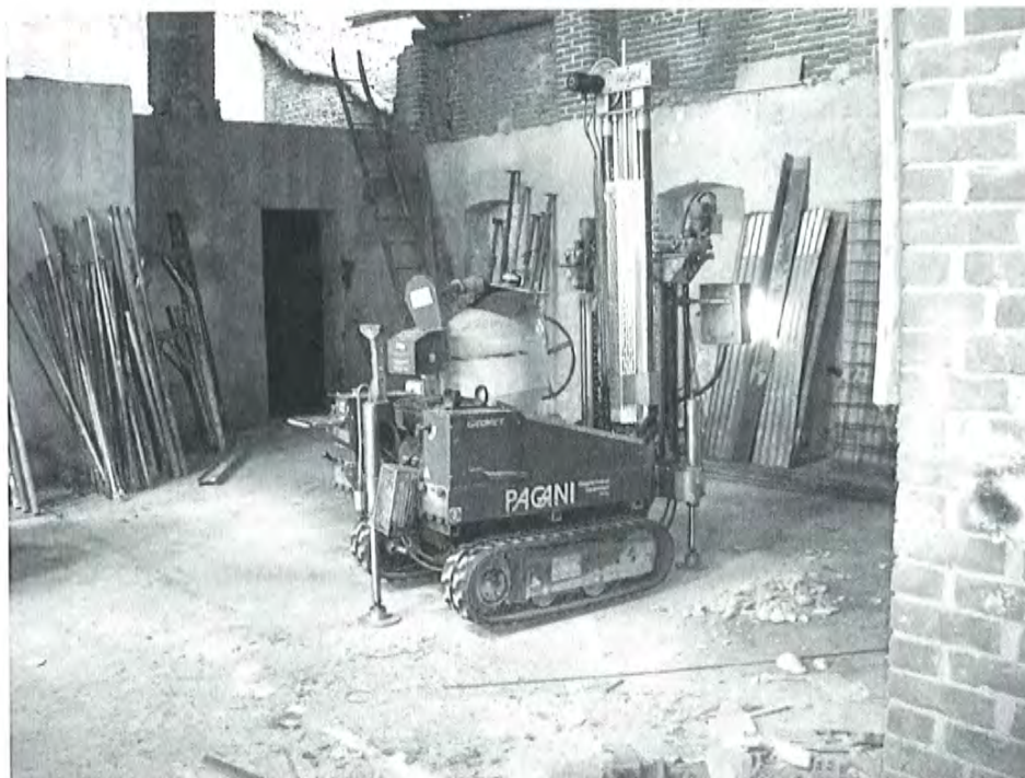
Foto 3 – L'esecuzione della prova penetrometrica DIN 3
